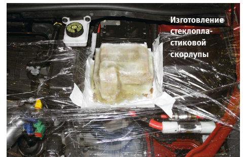
Передняя плоская крышка будет скрыта штатной дверцей бардачка
