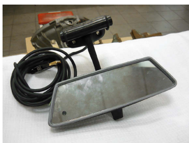
А ещё — веб- камера в зеркале и камера заднего обзора под ин- струментальной сумкой (большой)
