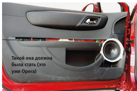
Динамик крепится через проставки на металл двери
