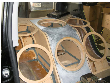
Корпус сабвуфера состоит из трёх «двухместных» блоков и собран воедино уже в машине
