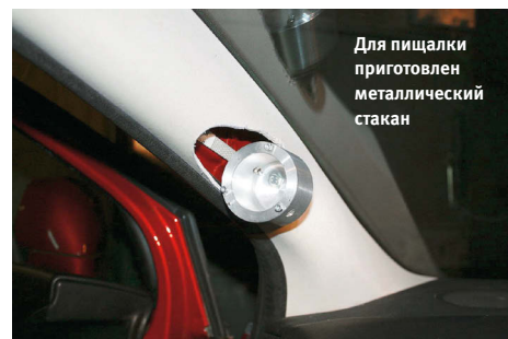
Он интегрируется в стойку выпуклым «обтекателем»
