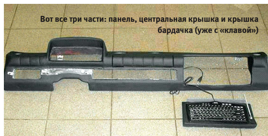
Центральный фрагмент торпедо откидывается, выпуская экран на свободу
