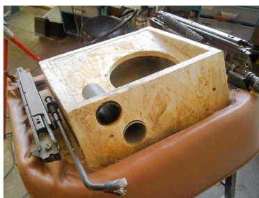
Диагональная перегородка делит объём на две камеры
