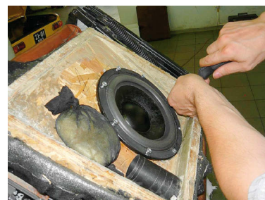
Диагональная перегородка делит объём на две камеры
