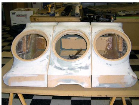
Корпус сабвуфера состоит из трёх «двухместных» блоков и собран воедино уже в машине
