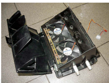
Штатный вентилятор отопителя заменён двумя малошумными компьютерными
