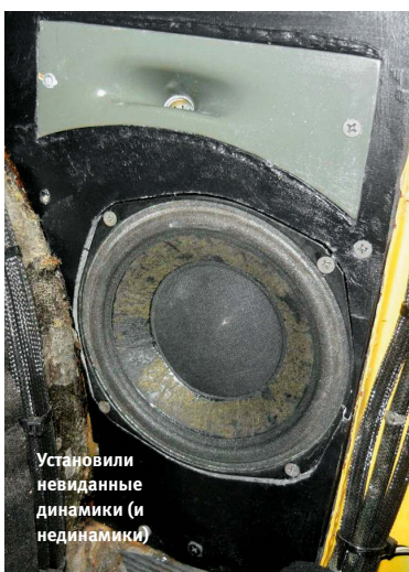
Раньше это была простая картонка, теперь — акустически прозрачная панель
