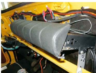
Центральный фрагмент торпедо откидывается, выпуская экран на свободу
